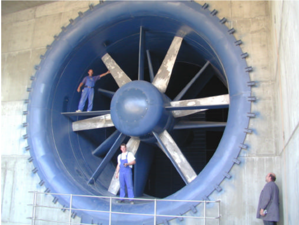
Fig. 6 ST2 Fan after erection
